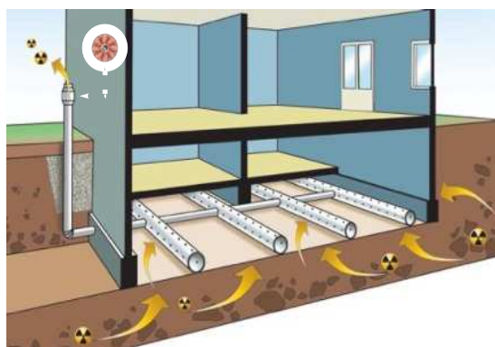
Fig. 5.38 - Sistema a platea con tubi di drenaggio
