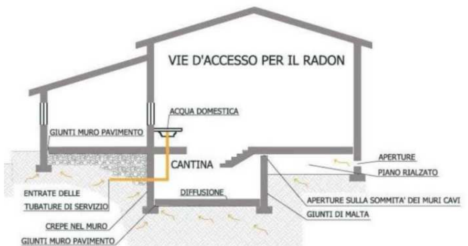
Fig. 5.5 – Possibili ingressi di radon in corrispondenza dei buchi per le canalizzazioni di servizio
