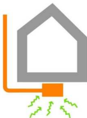
Fig. 5.19 – Depressione del suolo tramite pozzetto
