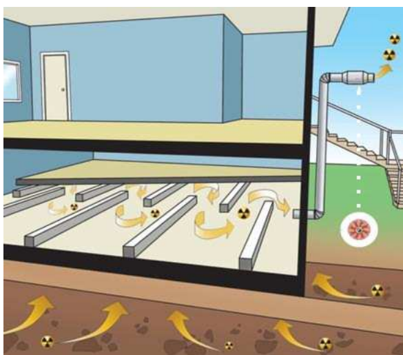
Fig. 5.36 - Aspirazione dell'aria con intercapedine
