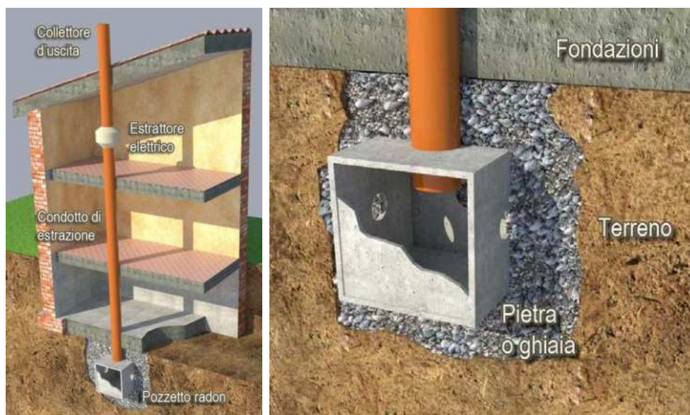
Fig. 5.22 – Esempio di pozzetti interni all'edificio
