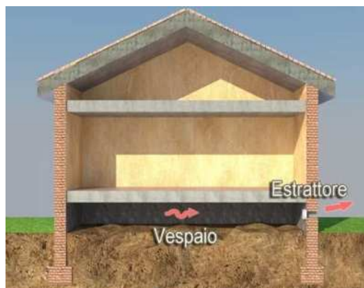
Fig. 5.27 - Aspirazione forzata del vespaio
